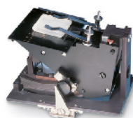
角度可调反射附件 反射角可调范围：11° - 60°， 样品尺寸：12x10 mm 2 ；80x230 mm 2 ； 样品厚度：20 mm
