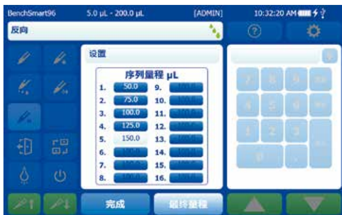
图 3-39: 设置序列中的最后一个量程
