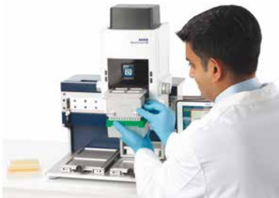
图 1-21: 使用空盒子来支撑移液头部
