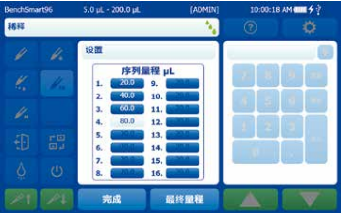
图 3-30: 设置序列中的最后一个量程
