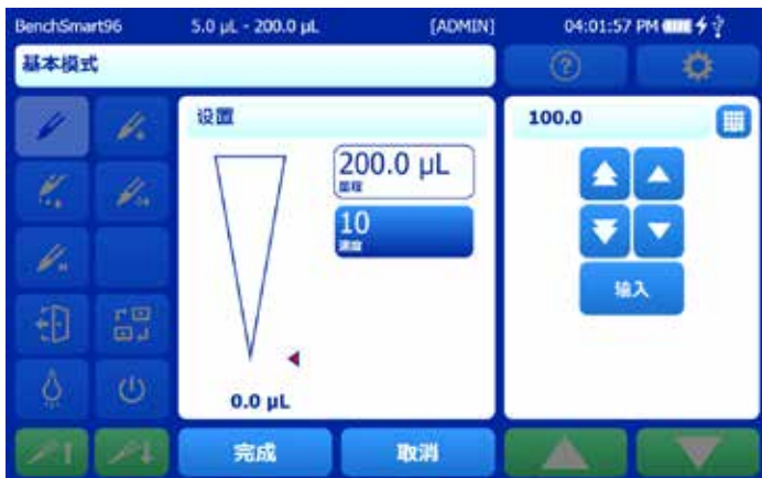
图 2-6: 使用箭头控件设置量程
