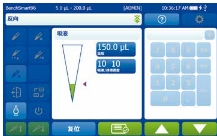
图 3-43: 不带“吹液”选项的反向移液
