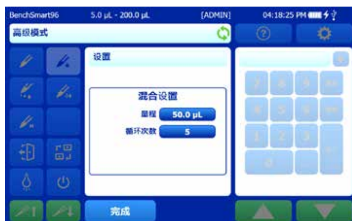
图 3-8: 设置混合量程和混合循环次数
