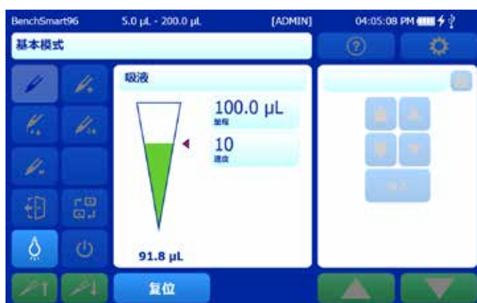
图 2-8: 表明吸头中吸液量的屏幕
