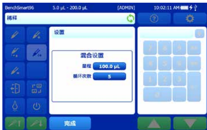
图 3-32: 设置混合量程和混合循环次数
