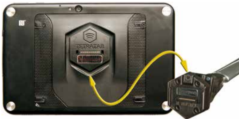
图 1-8: 支架和操作屏安装板
