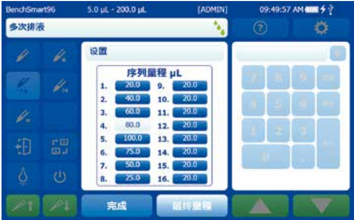
图 3-22: 设置序列中的最后一个量程
