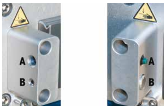
图 A-3: 带限位器 A 和磁铁 B 的液体配给头左限位器托架
