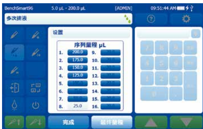
图 3-24: 设置序列中的最后一个量程
