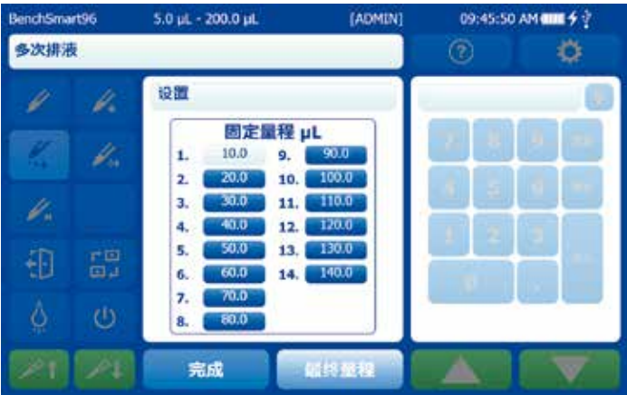
图 3-19: 设置一个固定量程
