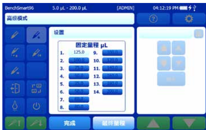
图 3-3: 设置一个固定量程
