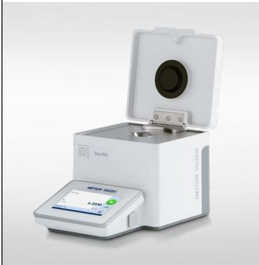
对于需要准确性和易用性的用户而言，数字折光率仪是理想之选，不仅测量简单、快速，且实验过程直观可见。高分辨率光学传感器可快速测量样品的折光率。
