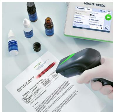
通过采用 SimpleCheck™ 的内置工作流程，仪器验证工作从未如此简单：无论您使用的是密度计还是折光率仪，您的仪器均可确保测量结果准确。
