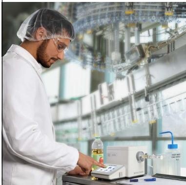
在生产车间、流水线测量密度：新式测量池设计可最大限度减小外部机械振动的影响，即使在晃动条件下也可取得精确结果。
