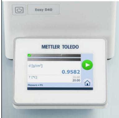
最大限度提高准确性的创新设计: 通过视频观察密度测量池, 并且使用我们的集成 BubbleCheck™ 算法避免因气泡或取样不正确造成的结果错误。
