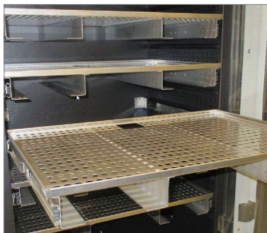
伸缩式抽拉导轨, 便于箱体内样品的装载或卸载
